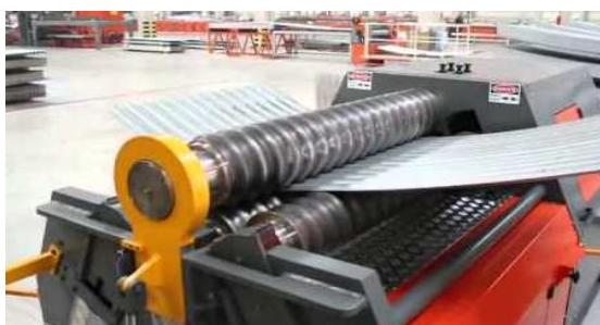
Las chapas curvadas se producen y curvan a medida según la necesidad del cliente, adaptándose a diferentes radios tanto para estructuras existentes como nuevas.
