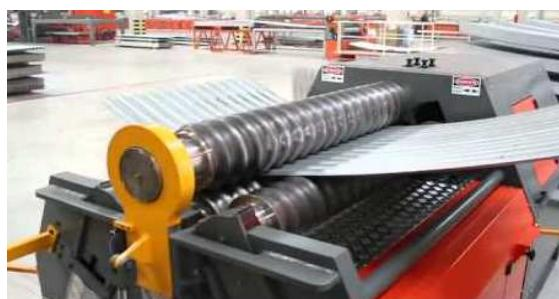
Las chapas curvadas se producen y curvan a medida según la necesidad del cliente, adaptándose a diferentes radios tanto para estructuras existentes como nuevas.
